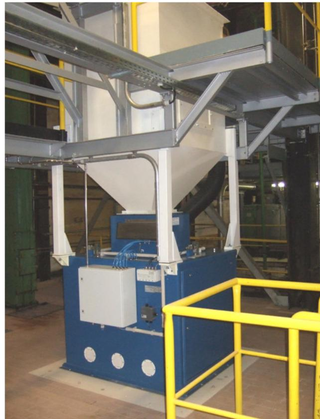
Elektronische Schüttwaage Typ 34.144
