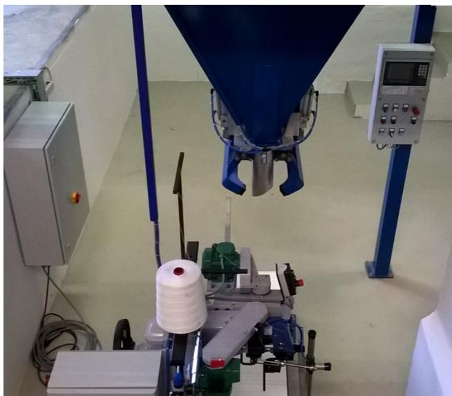
Nettoabsackwaage mit Nähmaschine
